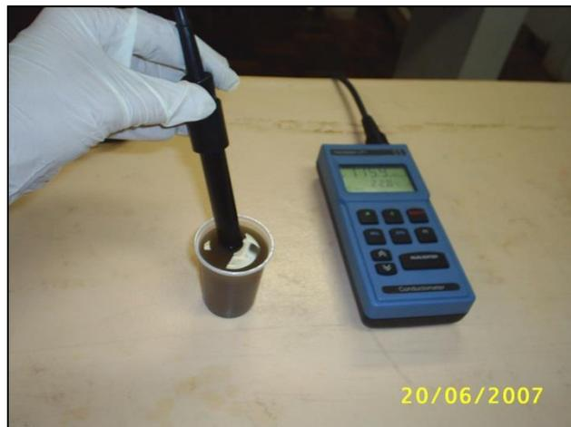
FIGURA 11 - Medição da condutividade elétrica na fração solubilizada
