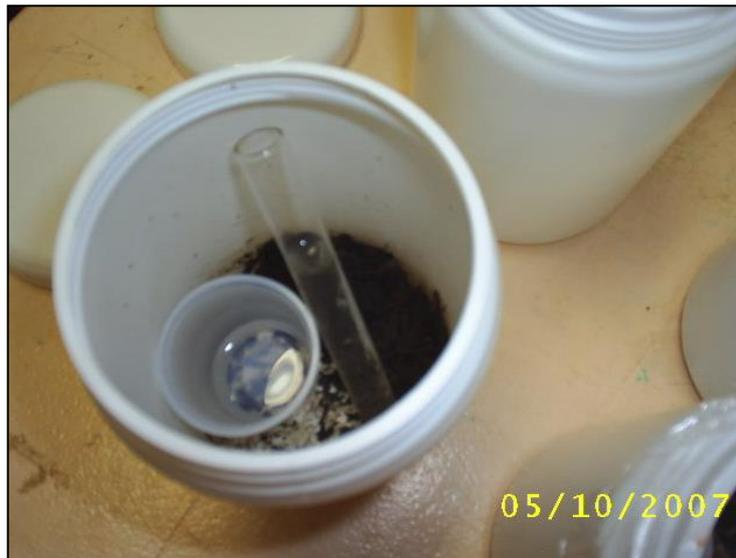
FIGURA 9 - Construção dos respirômetros para a captura de CO<sub>2</sub> produzido pela atividade microbiana
