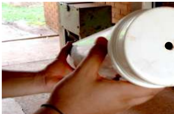
FIGURA 3 - DRENAGEM DAS COLUNAS DE SOLO MONTADAS
