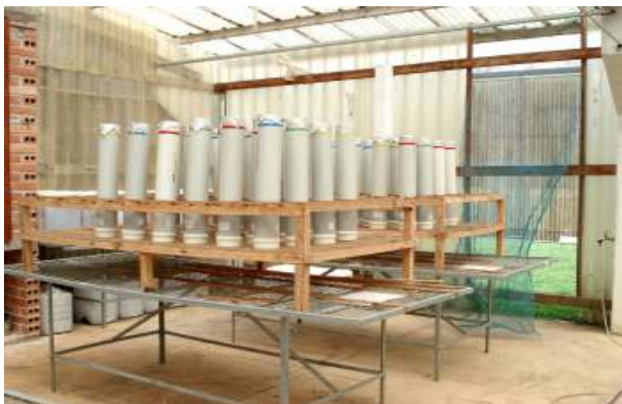
FIGURA 4 - COLUNAS DE PERCOLAÇÃO EM CASA DE VEGETAÇÃO.
