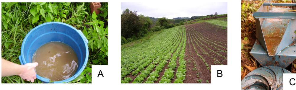
FOTO 1: A – VOLUME DE ESCOAMENTO NO BALDE DA ENCOSTA SOB CULTIVO ORGANICO, B - USO E COBERTURA DO SOLO SOB CULTIVO ORGÂNICO, C - ASPECTO DA RODA DE COSCHOCTON NA DATA DE COLETA DE 07 DE DEZ DE 07.
