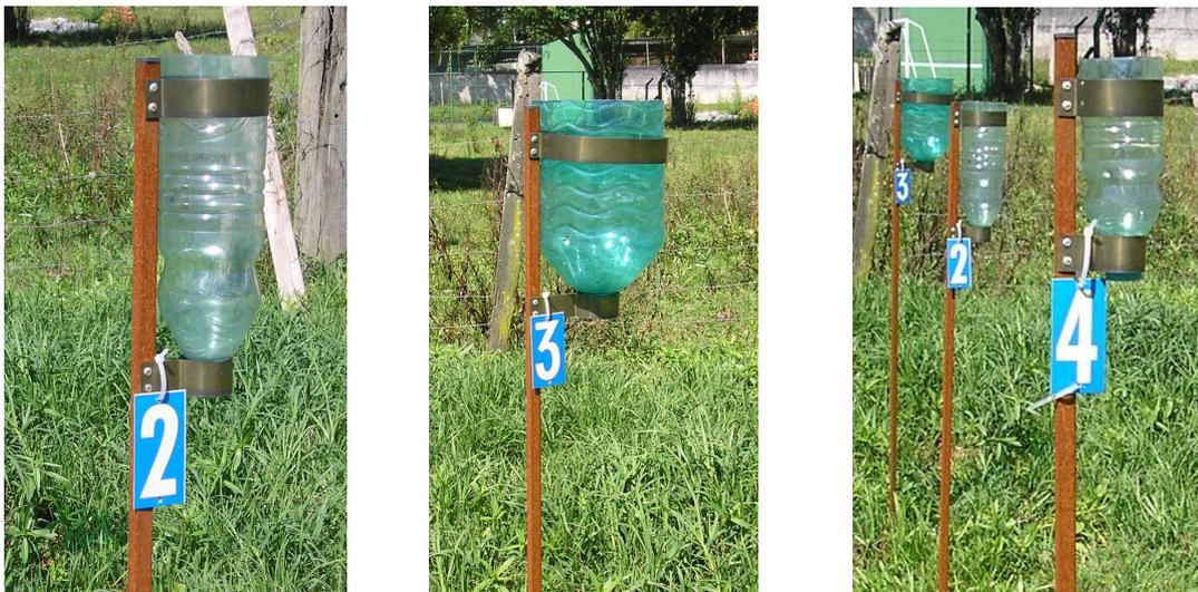
FIGURA 4.7 – Pluviômetros Alternativos 2, 3 e 4, construídos a partir de garrafas *PET* de mesma marca comercial e material, possuindo diferentes áreas de captação
