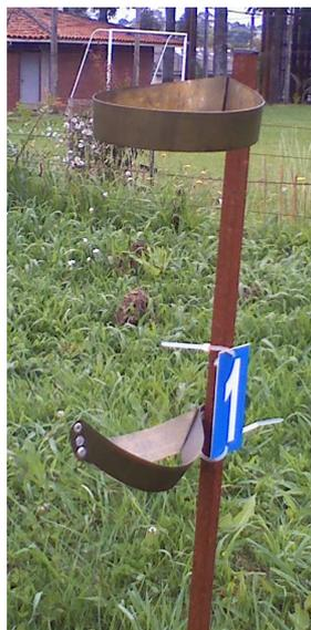
FIGURA 4.2 – Estrutura de sustentação dos pluviômetros, fixados em uma barra de ferro, a 1,5 m de altura da superfície do solo, contendo encaixes construídos de latão rebitado
