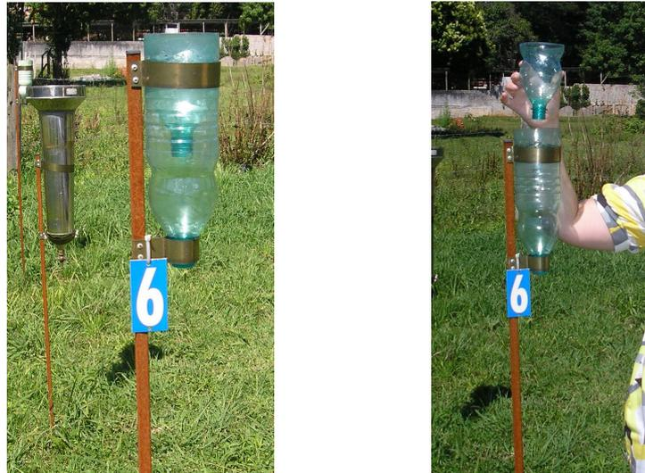
FIGURA 4.9 – Pluviômetro alternativo 6, construído a partir de uma garrafa *PET* e contendo um funil interno
