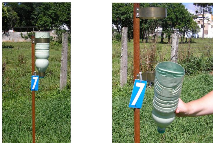
FIGURA 4.10 – Pluviômetro alternativo 7, construído a partir de uma garrafa *PET* e contendo pintura interna e externa com tinta acrílica
