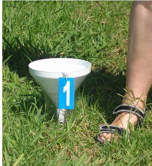
FIGURA 4.6 – Pluviômetro Alternativo 1, construído a partir de uma garrafa *PET* e de um funil plástico de 283,5 cm<sup>2</sup> de área de captação
