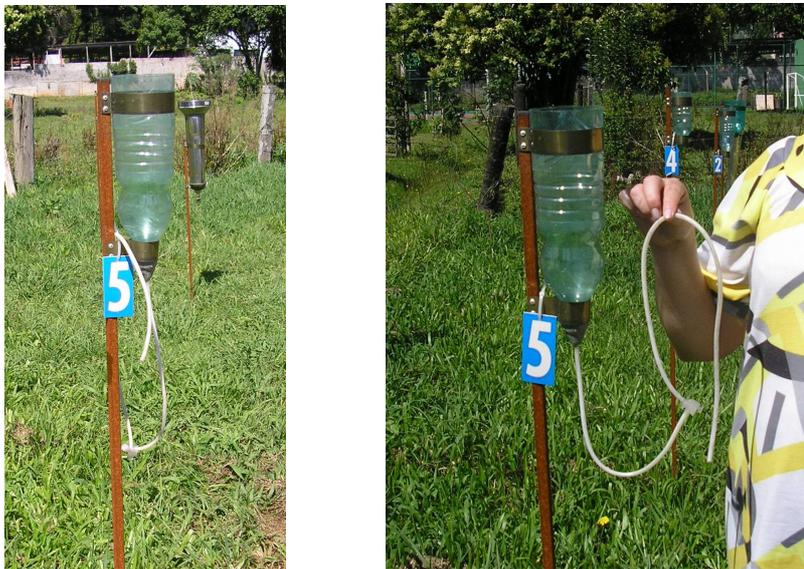
FIGURA 4.8 – Pluviômetro Alternativo 5, construído a partir de uma garrafas *PET* e contendo uma mangueira com torneira
