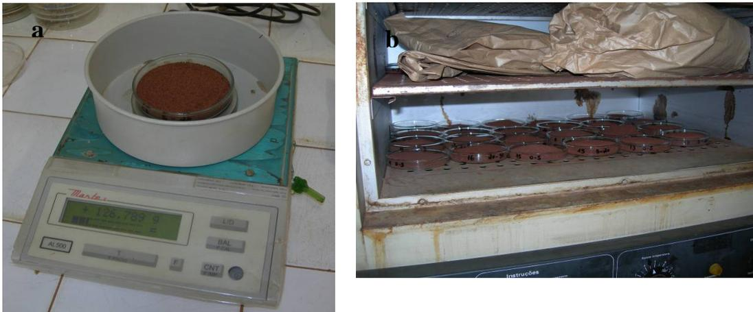
FIGURA 7– BALANÇA (a) E ESTUFA (b), UTILIZADAS PARA DETERMINAÇÃO DA UMIDADE DOS SOLOS DA USINA ALTO ALEGRE, MUNICÍPIO DE COLORADO – PARANÁ, DE NOVEMBRO 2007 A SETEMBRO 2008
