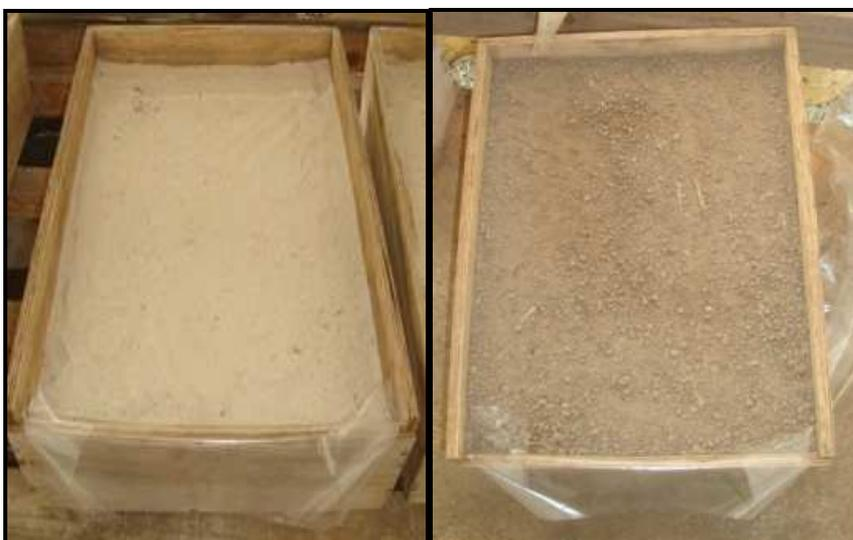
Figura 2.1. (A) Preenchimento das caixas de erosão com areia fina. (B) Caixa de erosão preenchida com a camada de 2,5 cm de solo com uma densidade se  $0,92 \text{ g cm}^3$ .
