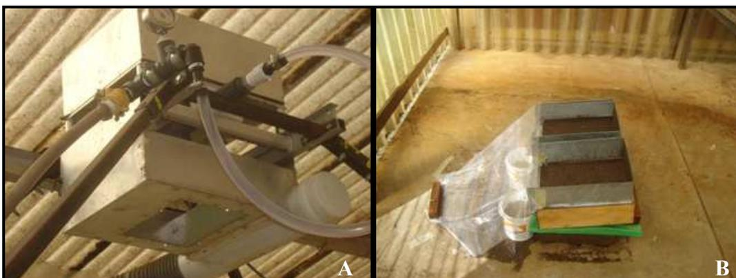
Figura 2.3. (A) Simulador de chuva programável. (B) Caixas de erosão com as calhas coletoras na declividade de 12%.
