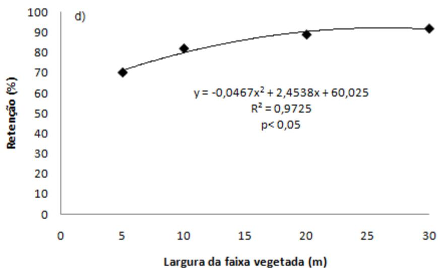
Figura 10. Retenção acumulada de N-Total (a), N-NH<sub>4</sub><sup>+</sup> (b), N-NO<sub>3</sub><sup>-</sup> (c) e N-Particulado (d) para cada largura de faixa vegetada de campo nativo a partir do início da coleta para as duas horas de simulação.
