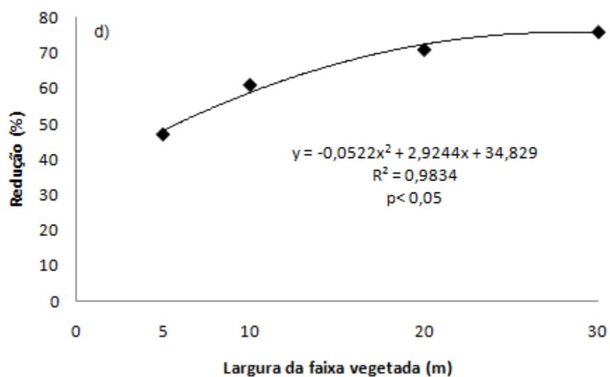
Figura 8. Redução da concentração média ponderada de N-total (a), N-NH<sub>4</sub><sup>+</sup>(b), N-NO<sub>3</sub><sup>-</sup>(c) e N-Particulado (d) em cada largura de faixa vegetada de campo nativo a partir do início da coleta para as duas horas de simulação.
