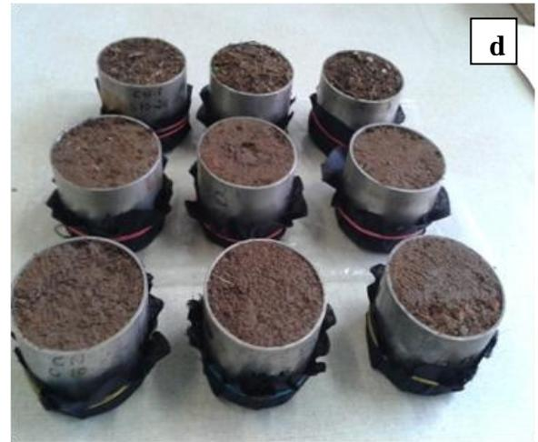
APÊNDICE 2. Leitura de  $\text{N-NO}_3^-$  e  $\text{N-NH}_4^+$  em espectrofotometria de absorção ultravioleta (a). Frascos Exetainers (Labtec) em cromatógrafo para leitura dos gases (b). Câmara coletora de gás com termômetro, bateria para ventilação e seringa para coleta do gás (c), Amostras indeformadas para determinação da densidade do solo (d).
